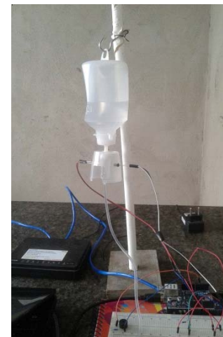
Figura 4 – Protótipo hardware-software desenvolvido para o OpenSerum.
