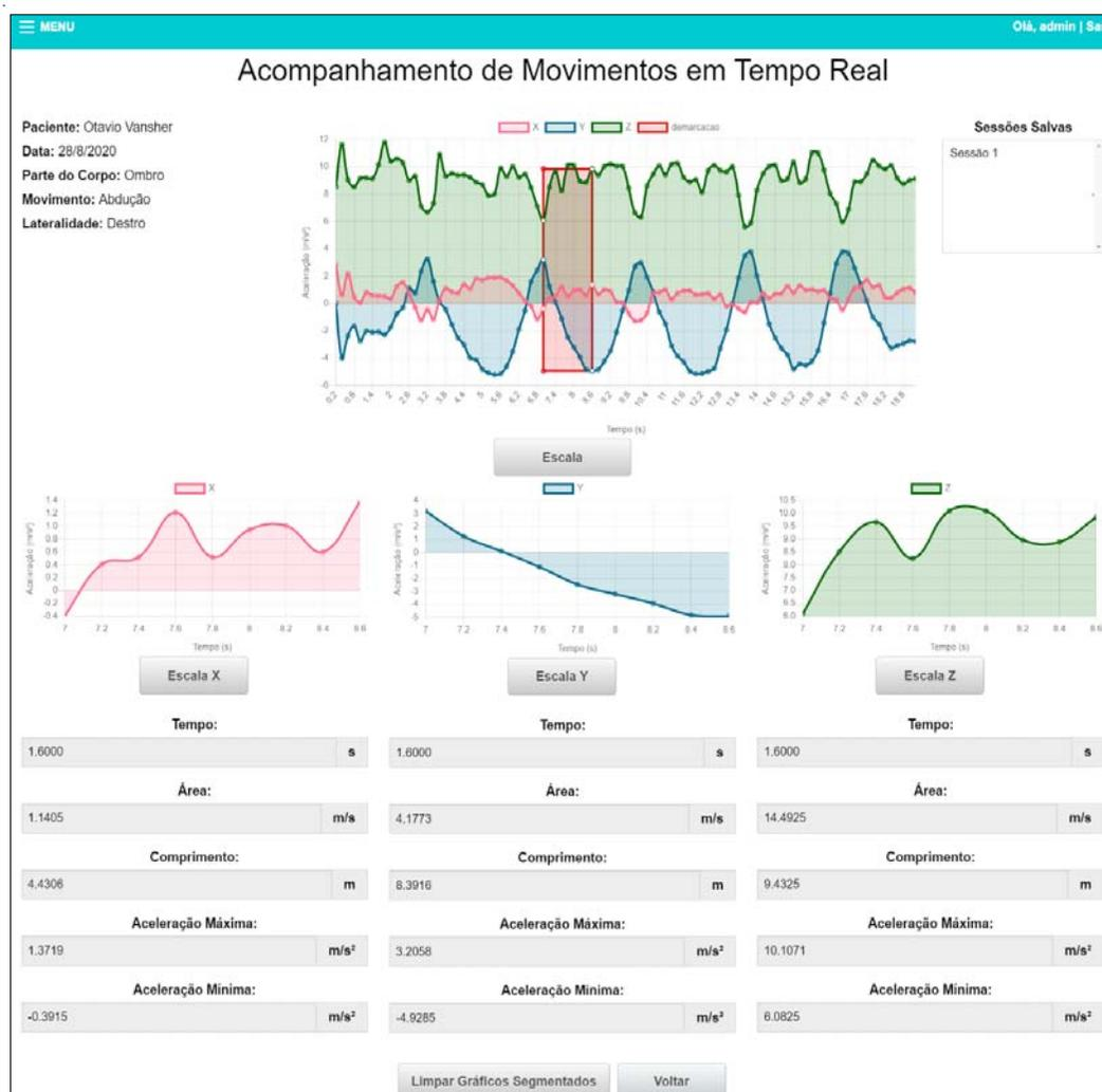
Figura 2 – Tela de acompanhamento de movimento em tempo real (acesso via receptor *notebook*). O trecho demarcado na porção superior da figura origina as demais curvas ilustradas
