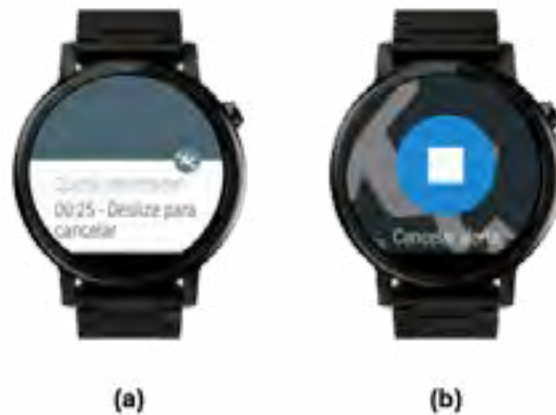
Figura 3: Capturas de tela do smartwatch . (a) Notificação com timer . (b) Opção de cancelar o alerta no smartwatch
