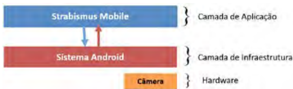
Figura 2: Diagrama de blocos da arquitetura do Aplicativo
