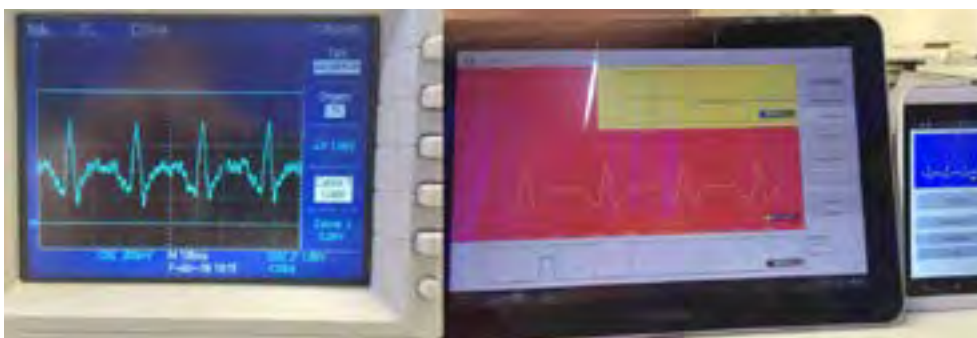
Figura 9: Tela do osciloscópio com o sinal amostrado, tablet executando o App1-paciente e apresentando o sinal de ECG na tela, e smartphone executando o App2-médico e apresentando o sinal de ECG na tela.
