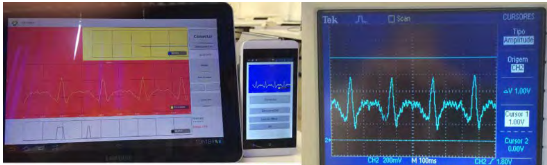
Figura 10: Tela do Osciloscópio com o sinal Amostrado, tela do Tablet executando App1 e Smartphone executando App2
